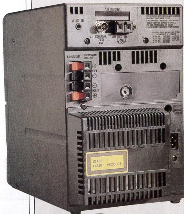
Decisamente scarno ed essenziale il retro dell'impianto, che permette solo i principali contatti con il mondo esterno, e cioè sistema di altoparlanti, ingresso aux mini jack e antenne AM e FM, quanto basta per non essere esclusi; la particolarità sta invece nel piccolo connettore sotto la presa per la 220 volt di casa, che permette al JVC di essere alimentato a corrente continua a 12 volt (toh, posso usarlo in automobile, in camper...).
